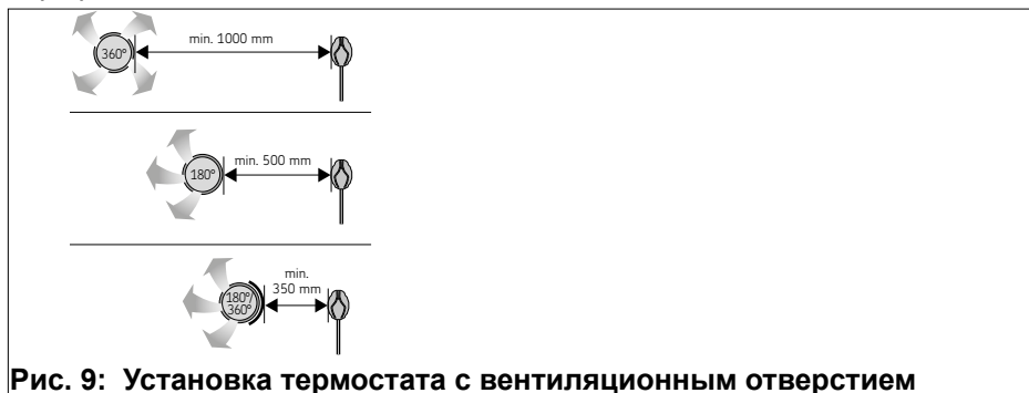
Рис. 9: Установка термостата с вентиляционным отверстием
